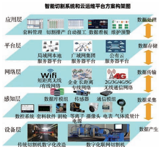
图1 智能数字切割管理系统(IDCS)架构
